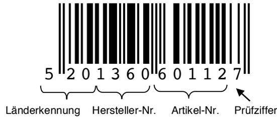
Auch bei den GTIN-13-Codes kann man die Prüfziffer berechnen. Das funktioniert im Grunde genauso, wie oben für die GTIN-8-Codes beschrieben. Allerdings beginnt man diesmal die Multiplikation mit 1 und wechselt dann zur 3 und so weiter. Im Anschluss wird wieder aufsummiert und die Zahl, die zur vollen Zehnerzahl fehlt, ist die Prüfziffer.
