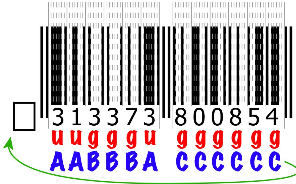
Die erste codierte Ziffer besteht aus insgesamt fünf schwarzen Balken und zwei weißen Leerstellen. Da die Anzahl der schwarzen Balken **ungerade** ist, lautet die Regel, dass diese Ziffer nach **Codereihe A** codiert werden muss.
